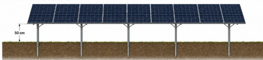
Figura 4 Pianta e Prospetto schema tipo modulo fotovoltaico
